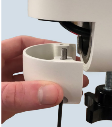
Rysunek 14: Ponowny montaż obudowy
