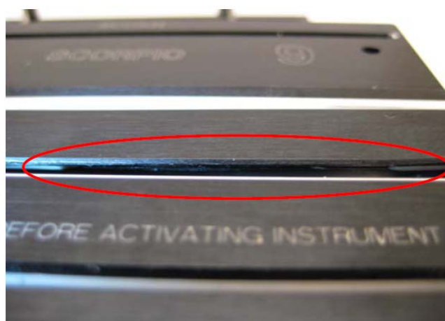
Rycina 9. Brak szyny w bloku ceramicznym.
