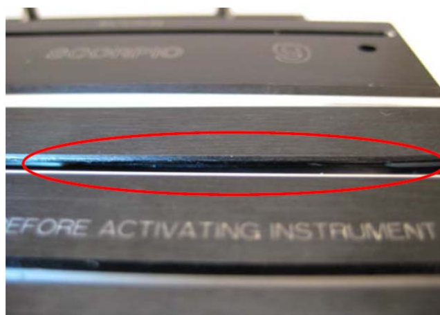
Rycina 16. Brak szyny w bloku ceramicznym.
