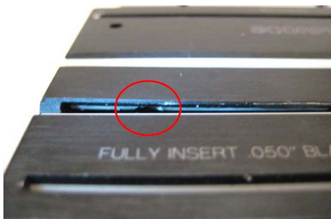
Rycina 15. Blok ceramiczny z wyszczerbioną szyną.
