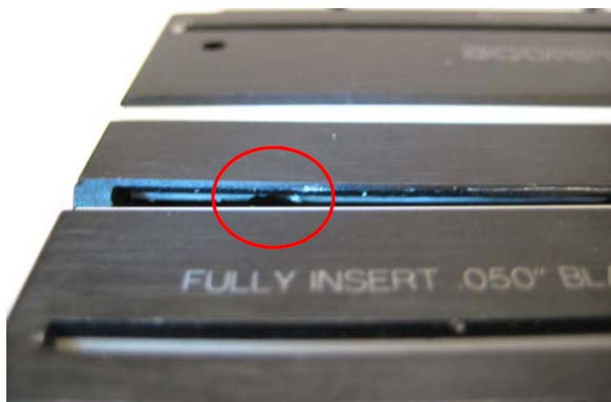
Rycina 8. Blok ceramiczny z wyszczerbioną szyną.
