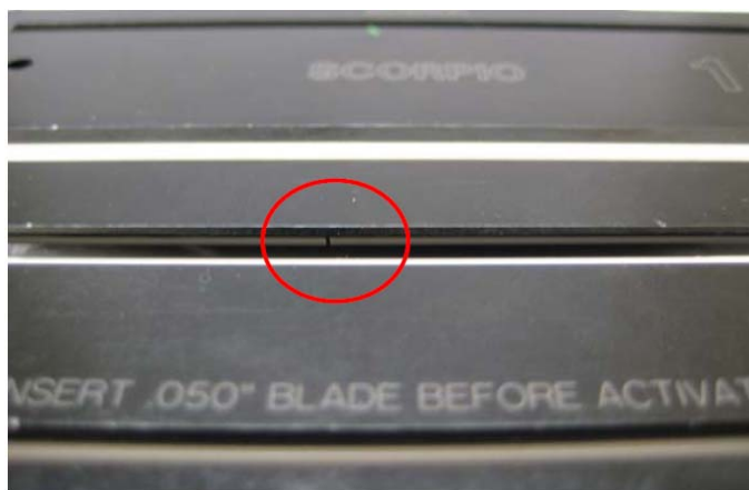
Rycina 14. Blok ceramiczny z pękniętą szyną.
