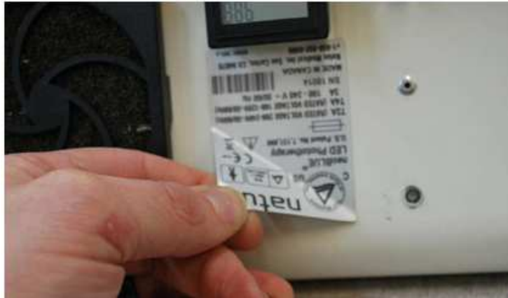
Rys. 3 Odkleić od obudowy tabliczkę z numerem fabrycznym
