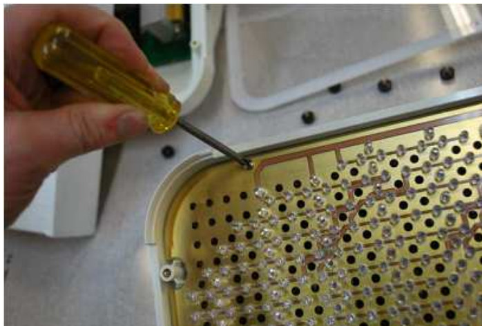
Rys. 6 Urządzenie po zdjęciu obudowy, z odsłoniętym drukowanym obwodem panelu LED
