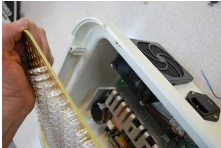
Rys. 7 Panel LED zdjęty z obudowy
