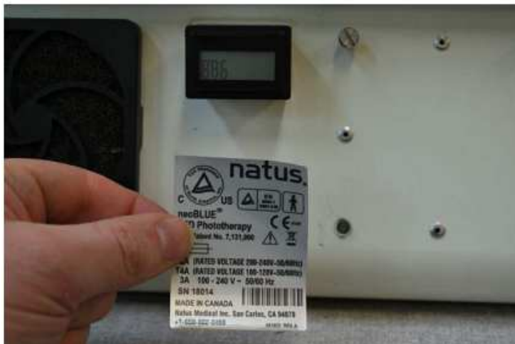
Rys. 4 Usunąć tabliczkę z numerem fabrycznym z obudowy lampy
