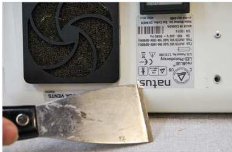
Rys. 2 Przy pomocy noża o ostrej krawędzi podważyć brzeg tabliczki z numerem fabrycznym
