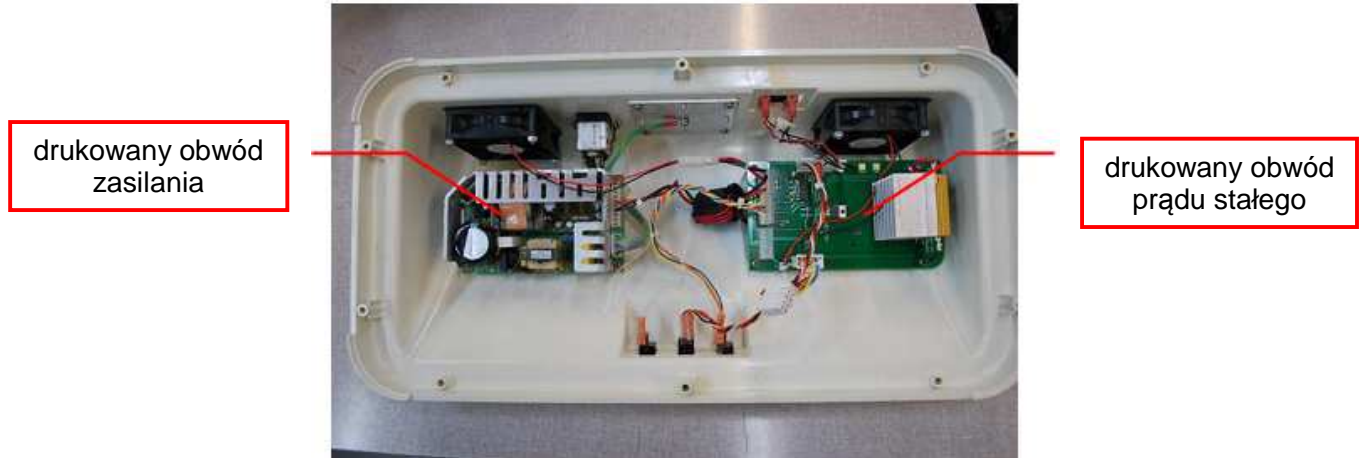
Rys. 9 Widok urządzenia po zdjęciu dyfuzora i obwodu drukowanego panelu LED
