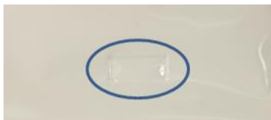
Rysunek B – nowy, szczelny zgrzew
