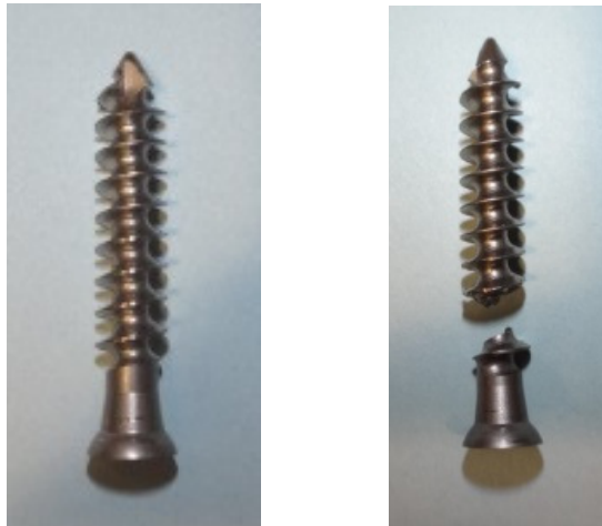
Nieuszkodzona śruba 35mm (po lewej) i pęknięta śruba 35mm (po prawej)
