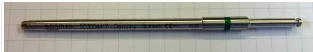
Nieprawidłowo wytrawiane laserowo: Ostrze śrubokrętu Cross-Lock Mid 1.7, końcówka stomatologiczna; partia (16688) artykuł (503004417)
