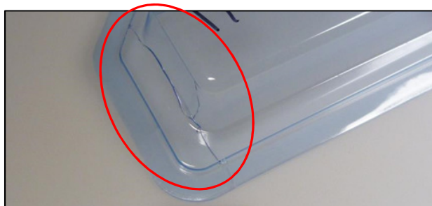
Zdjęcie 2) Uszkodzenie tacki zewnętrznej
