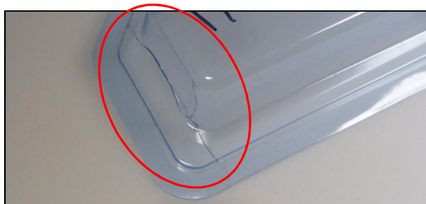
Zdjęcie 2) Uszkodzenie tacki zewnętrznej
