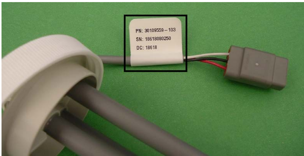
Rycina 1. Etykieta identyfikacyjna czujnika poziomu roztworu roboczego
