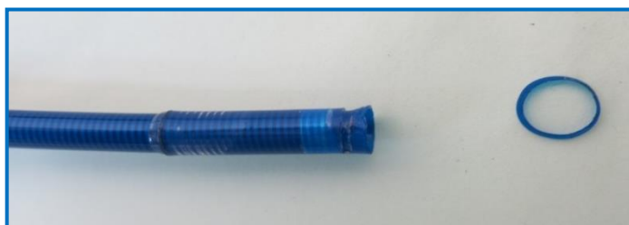
Rysunek 1c: mały odcinek zwężanej końcówki niebieskiej koszulki odłączony od kołnierza suwaka po wycofaniu wyrobu
