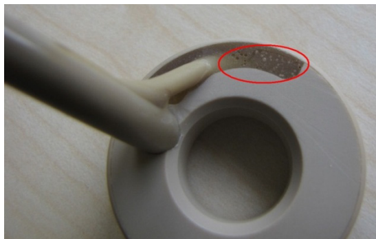
Rycina 1: Bardzo drobne otwory w kleju
