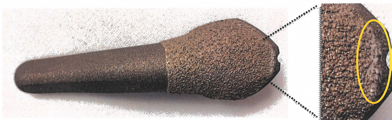
Rys. 2: Pozostałości PETG na trzpieniach PTC (cząstki) Pozostałości mają postać małych, białych cząstek
