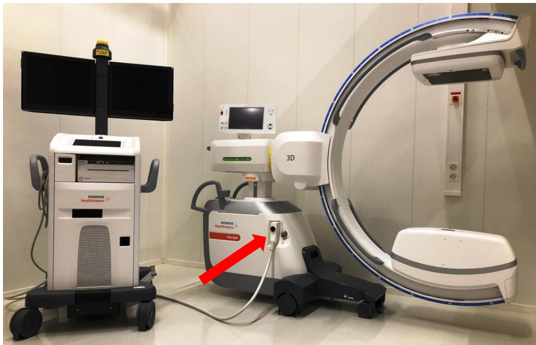
ilustracja 1: przykład złącza X10 z przewodem głównym podłączonego do ramienia C systemu Cios Spin
