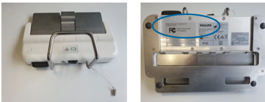
Ilustracja 1: Umieszczenie etykiety na spodzie przełącznika nożnego
