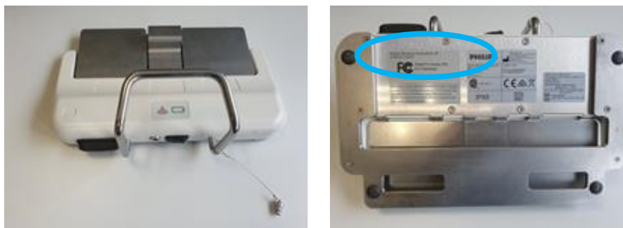
Rysunek 1: Umieszczenie etykiety na spodzie przełącznika nożnego
