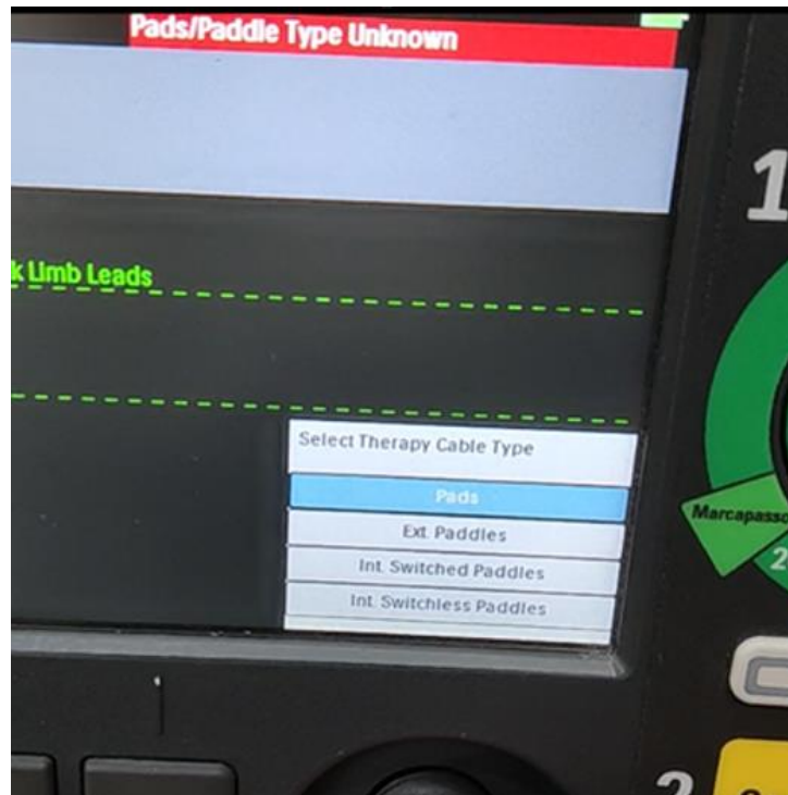
Ilustracja 1: wyświetlacz monitora/defibrylatora DFM100, w którym wystąpił problem z identyfikacją łyżek.
