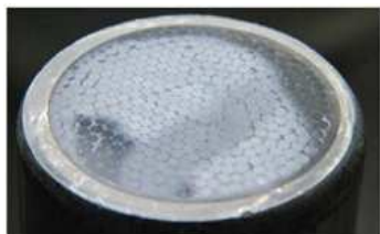
Ryc. 1: Wkładka sprawna Stan dobry, wkładka nadaje się do dalszej eksploatacji
