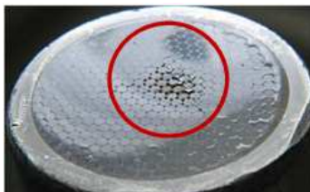
Ryc. 2: Wkładka ze śladami uszkodzenia Ślady uszkodzenia. Możliwa konieczność wymiany wkładki
