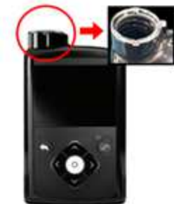
Zdjęcie: Lokalizacja obręczy w pompie insulinowej serii MiniMed™ 600
