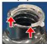
USZKODZONA obręcz komory pompy
