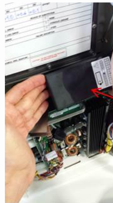
Aby wyjąć akumulator z PSU, należy prowadzić go w pozycji pochylonej
