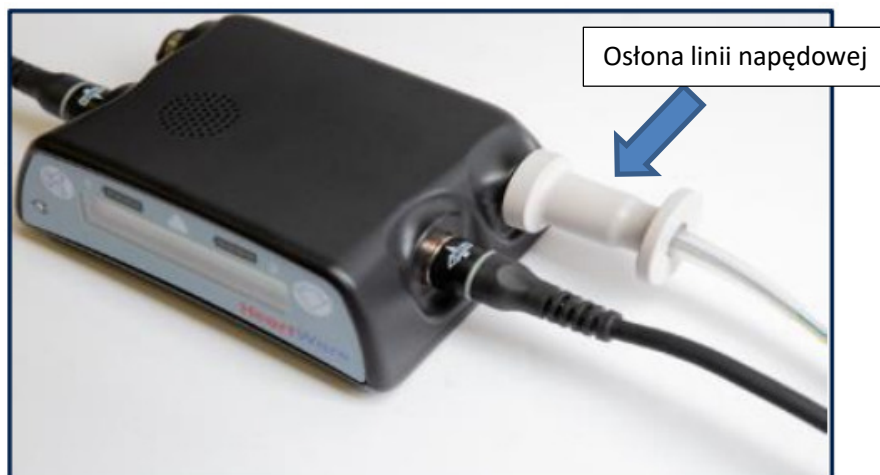
Rycina 1: Sterownik z osłoną linii napędowej zainstalowaną na złączu linii napędowej
