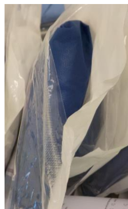
Rysunek 2: Wada zgrzewu
