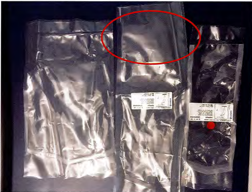
Rycina 1: Lewa część fotografii — ochronna torebka zewnętrzna; środkowa część fotografii — druga torebka opakowaniowa (pierwsza, czyli zewnętrzna, bariera sterylna) z brakującym zgrzewem uszczelniającym; prawa część fotografii — trzecia torebka opakowaniowa (druga, czyli wewnętrzna, bariera sterylna)
