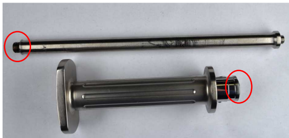
Rysunek 1: możliwe błędy spawania.
