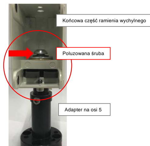
Rys. 2: Poluzowana śruba łącząca ramię wychylnie z przystawką optyki
