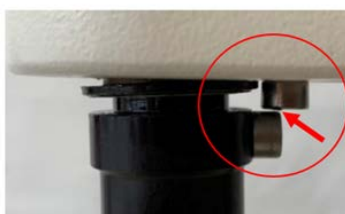
Rys. 4: Szczegółowy widok śruby blokującej w przypadku uszkodzenia urządzenia M220 F12: Śruby blokujące nie działają w sposób prawidłowy, umożliwiając swobodny obrót >360°. → Należy bezzwłocznie zaprzestać użytkowania urządzenia! Urządzenia M220 F12 nie wolno dalej używać.
