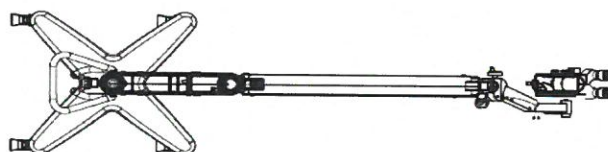
Rys. 3: Mikroskop Leica M525 F20, widok od góry Niepożądane , nieprawidłowe ustawienie: Ramię wychylne i ramię poziome znajdują się w pozycji całkowicie wyprostowanej
