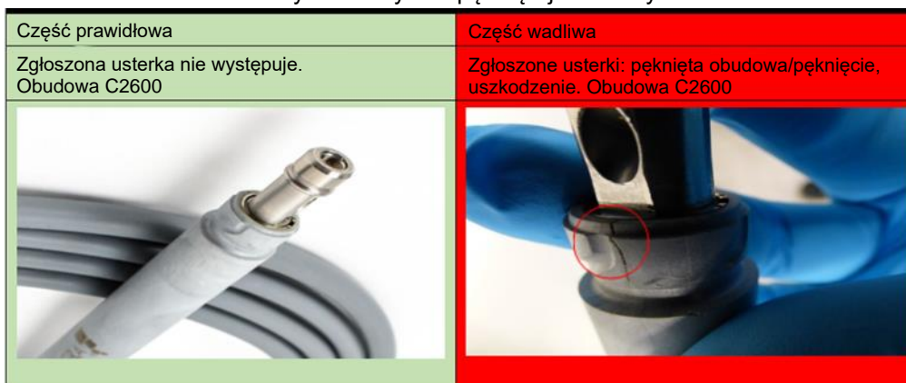
Rys. 1: Przykład pękniętej obudowy
