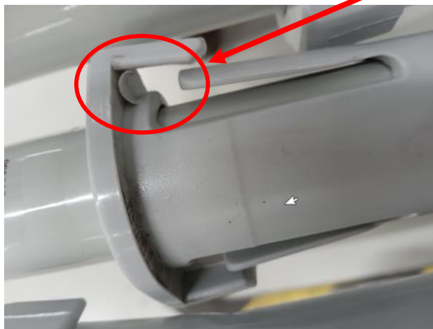
Ilustracja 1: Łącze barierki bocznej z zadziorem
