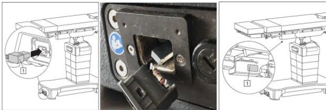
Rys. 1: Położenie przyłącza sieciowego na stole operacyjnym / wyciągnięte przyłącze sieciowe z odsłoniętymi elementami elektronicznymi / położenie etykiety produktu na mobilnym stole operacyjnym MEERA, w tym numer seryjny (SN).
