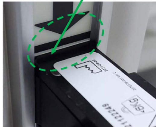
Rys. 4 Prawidłowy montaż (pełny kontakt bez szczeliny) elementu montażowego o przekroju trapezowym z szyną trapezową
