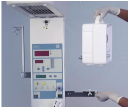
Rys. 2 Odłączyć i zdemontować urządzenie Lullaby™ Resus Plus/Prime z akcesorium montażowego o przekroju trapezowym.
