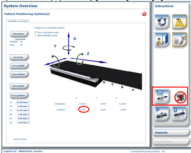
Rys. 7: Prawidłowe wskazanie pozycji 3D; blokada EXTERNAL INHIBIT jest ustawiona
