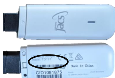
Rysunek 1. Ilustracja przedstawiająca przód/tył adaptera komórkowego LATITUDE MIMIC 4G, etykietę CID, w tym numer seryjny.
