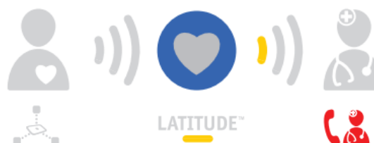
Rysunek 3. Góra: Jeśli transmisja danych do systemu LATITUDE nie przebiega pomyślnie, na komunikatorze zostanie wyświetlona jedna żółta fala wskaźnika Wysyłanie fal. Dół: Jeśli stan alarmowy wszczepionego urządzenia nie zostanie przetransmitowany, na komunikatorze wyświetli się czerwona ikona Skontaktuj się z lekarzem.
