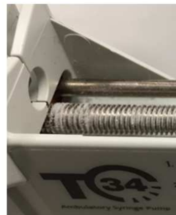
Rysunek 1: Śruba pociągowa i białe plastikowe zanieczyszczenia
