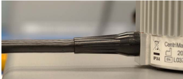
Rycina 4: Odgiętka kabla na Silniku
