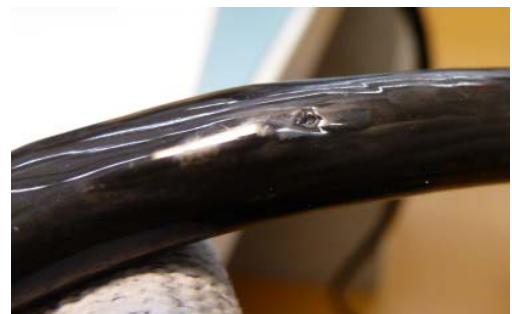
Rycina 8: Uszkodzony kabel Silnika
