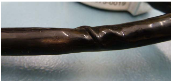
Rycina 7: Uszkodzony kabel Silnika
