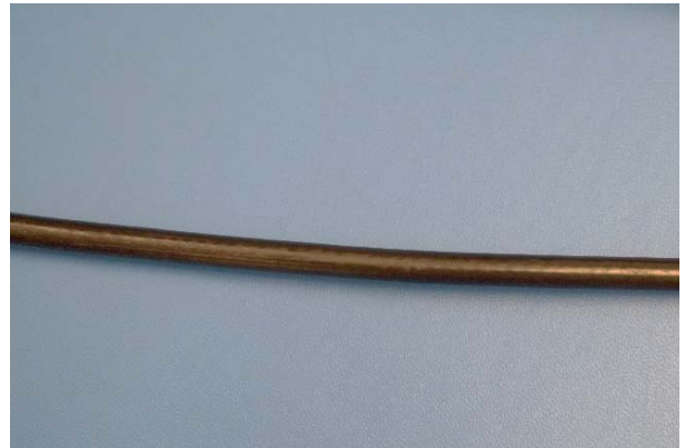
Rycina 6: Nieuszkodzony i nienaruszony kabel Silnika
