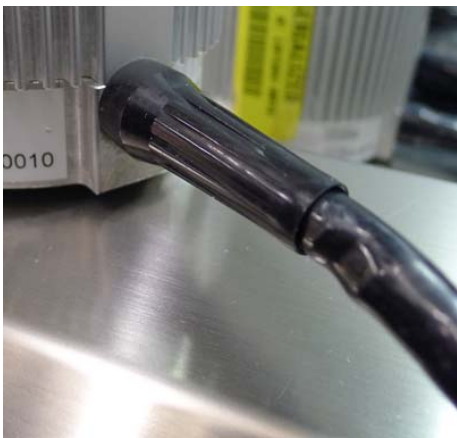
Rycina 5: Uszkodzenie kabla przy odgiętcie Silnika
