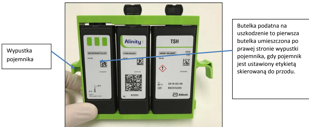
Rycina 1: Zlokalizowanie butelki podatnej na uszkodzenie
