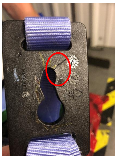
Ilustracja 2: Zdjęcie uszkodzonego zacisku nosidła
