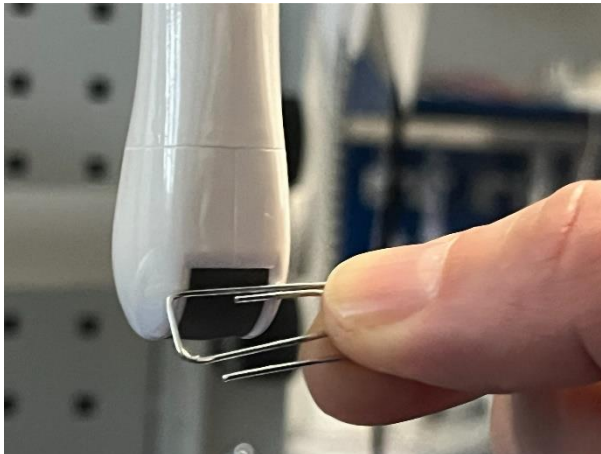
Rysunek 1: Procedura testu podwójnego obrazu. Umieścić metalowy odbłyśnik (pokazany spinacz) na krawędzi pola widzenia. Prowadzić odbłyśnik wzdłuż pełnej krzywizny przetwornika.
