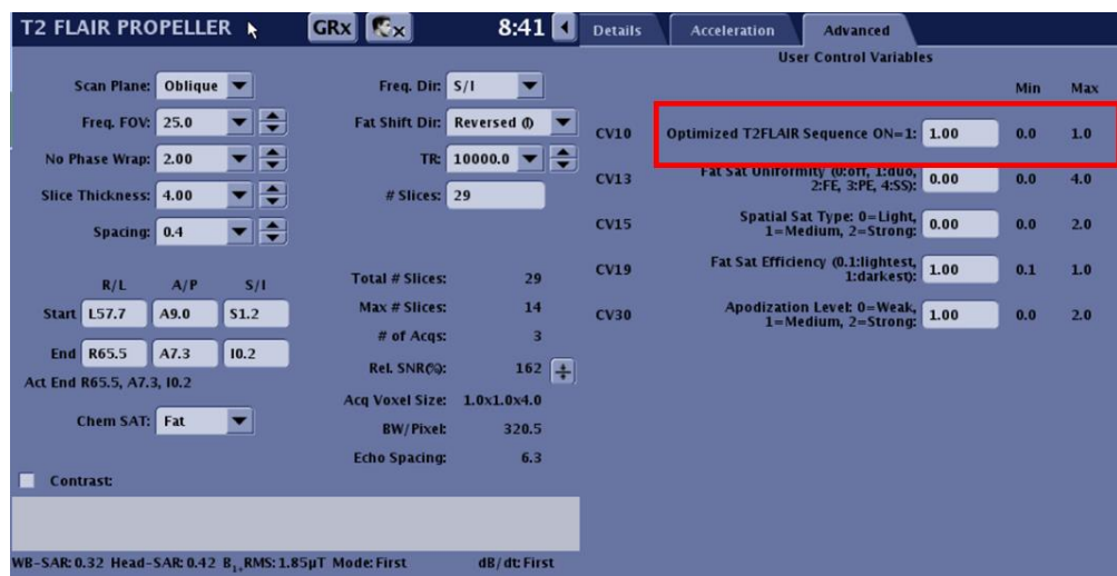
Rysunek 4. Włączona sekwencja Optimized T2 FLAIR (ustawiona na 1,00) pod zakładką „Zaawansowane” dla T2 FLAIR Propeller
